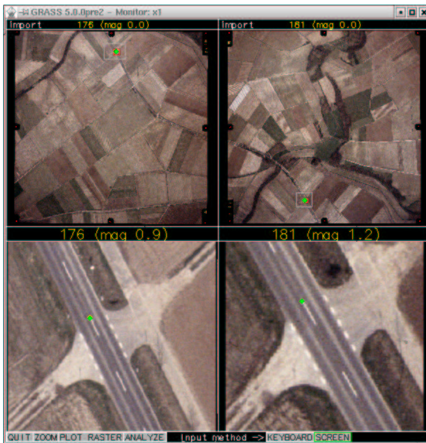
Abbildung 9.4: Nutzung von i.points zur Identifizierung von Passpunkten in Orthophotos
