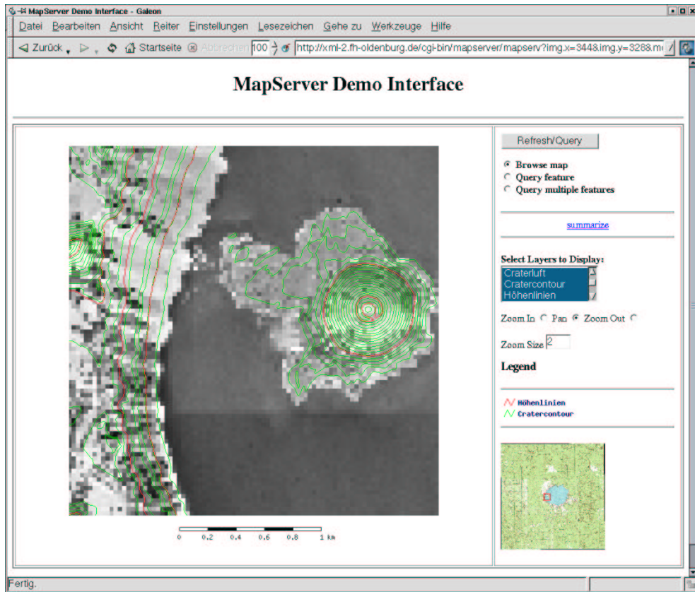
Abbildung 13.7: Vergleich der GRASS-Höhenlinien (rot) mit den USGS-Contourlines (grün) in MapServer
