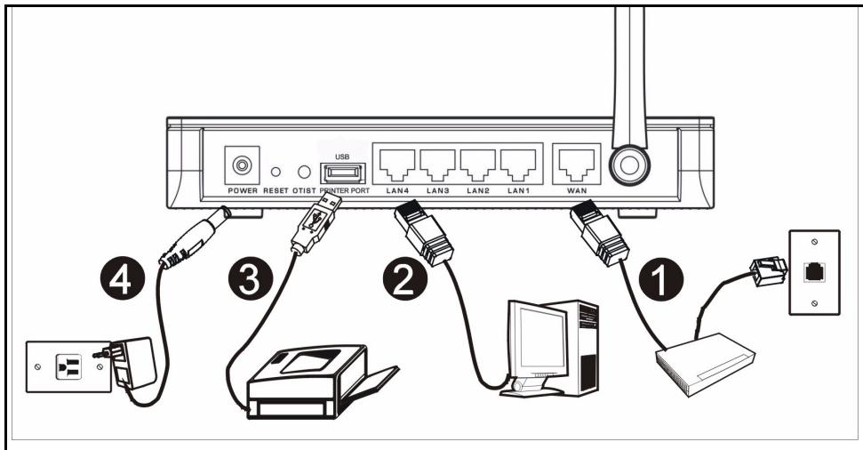
Di seguito sono illustrati i collegamenti hardware per l'installazione iniziale.
