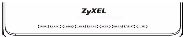
Los LEDs **LAN** y **WAN** se encenderán si se realizan correctamente las conexiones correspondientes.
