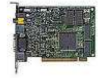
MPEG Decoder Karte (DXR3) mit TV Out
