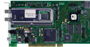
DVB Karte mit MPEG Decoder
